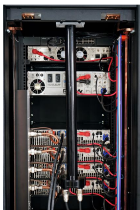
TUBO TRANSFORMADOR DE SALIDA DE RF
